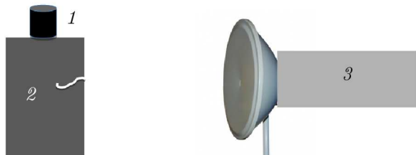
Рис. 3. Схема тестирования модуляции электромагнитной волны колебаниями: 1 — вибратор, 2 — тестируемый предмет с трещинами, 3 — микроволновый радар
