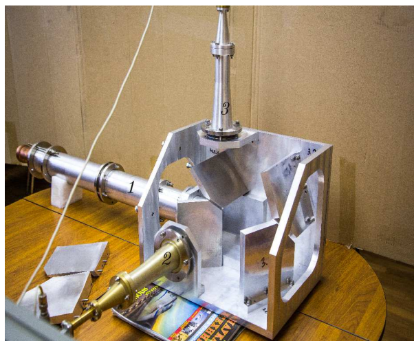
Рис. 2. Фотография электродинамической части экспериментальной установки: 1 — волноводный выходной тракт гиротрона, соединяющий резонатор и преобразователь, 2 — выходной рупор магнетрона, 3 — вывод излучения гиротрона в калориметрическую нагрузку
