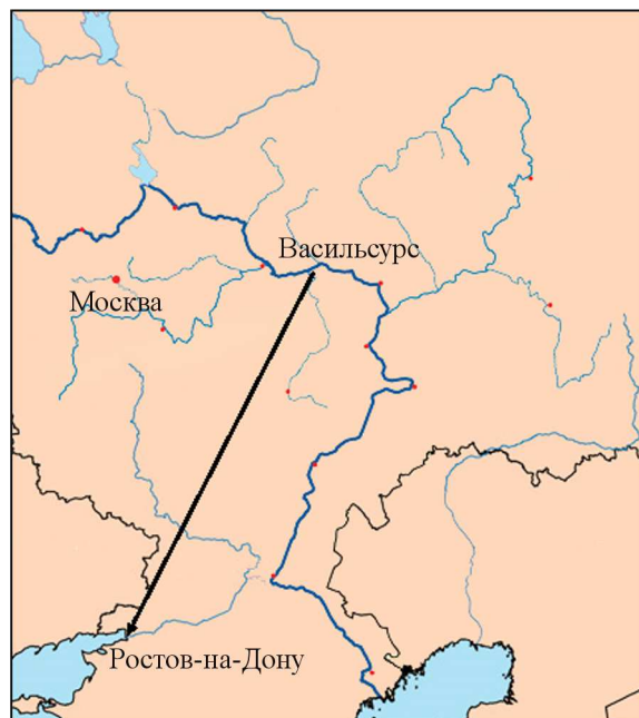
Рис. 1. Схема эксперимента: трасса наклонного зондирования Васильсурск (Нижегородская обл.)—Ростов-на-Дону
