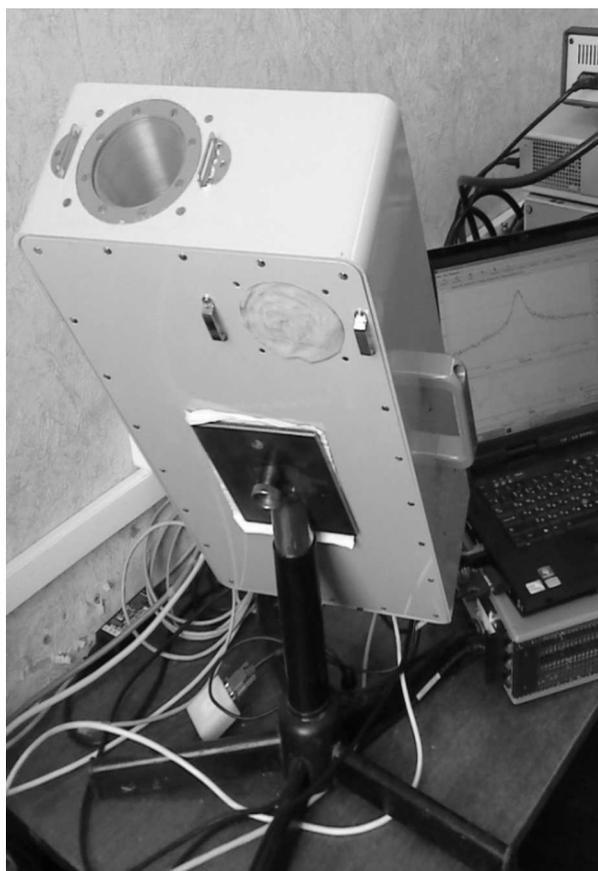
Рис. 6. Внешний вид спектро радиометра для термического зондирования стратосферы
