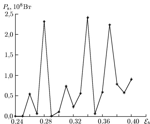
Рис. 7. Зависимость суммарной мощности  $P_s$  сверхтока, характеризующая излучение в открытое пространство, от напряжения смещения. Видна большая изрезанность кривой, которая обусловлена сильной зависимостью электродинамических параметров связи и условий согласования от частоты
