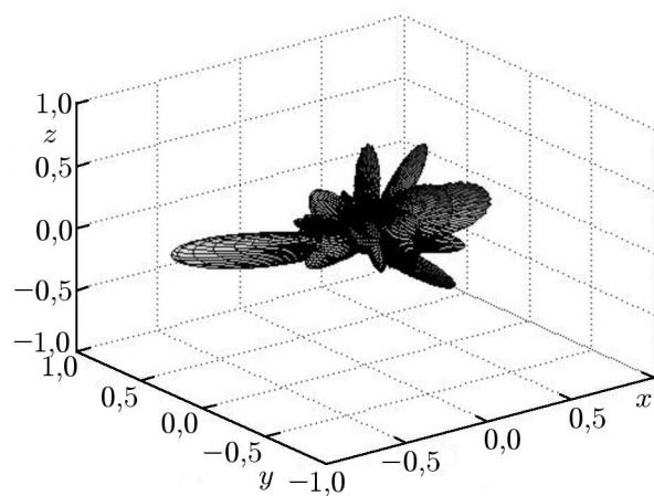
Рис. 8. Диаграмма направленности излучения, создаваемого моделируемой джозефсоновской антенной, для напряжения смещения 0,34 В, соответствующего максимуму мощности сверхтока, показанному на рис. 7. Видна выраженная асимметрия излучения в направлении оси  $x$ , что свидетельствует о реализации режима бегущей волны. Многолепестковость диаграммы обусловлена большим (по сравнению с длиной волны излучения) размером антенны
