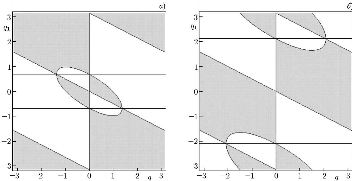
Рис. 2. Области устойчивости и неустойчивости режима бегущей волны на плоскости  $(q, q_1)$  для  $\omega_{Jd}/v = 0,3\pi/2$  (а) и  $\omega_{Jd}/v = 1,3\pi/2$  (б). Волновой импеданс линии равен  $z_w = 4$ , потери  $\nu/v = 0,01$ . Горизонтальными линиями отмечены волновые числа устойчивых решений типа бегущей волны. Видно, что с ростом параметра  $\omega_{Jd}/v$  волновое число устойчивой бегущей волны также растёт
