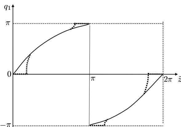
Рис. 3. Зависимость волнового числа бегущей волны  $q_1$  в устойчивом режиме от элементарного периода  $\tilde{z} = \omega_{Jd}/v$ . Пунктирными линиями показано искажение зависимости  $q_1(\tilde{z})$  и возникновение чисто синфазных и чисто противофазных режимов из-за включения индуктивных закороток, делающих линию передачи периодической, с конечными запрещёнными зонами, даже в отсутствие джозефсоновских контактов
