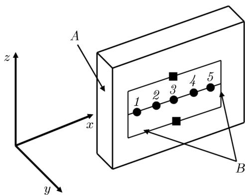
Рис. 5. Схема простейшей джозефсоновской антенны, представляющей собой прямой провод с включёнными джозефсоновскими контактами 1–5, размещёнными на диэлектрической подложке A. Кружками показаны джозефсоновские контакты, квадратами — батареи питания, идеальные провода обозначены буквой B. Также показана используемая система координат
