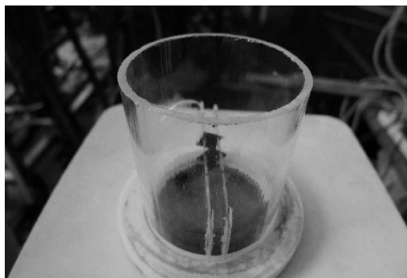
Рис. 3. Кварцевый цилиндр с установленными над смесью порошков молибдена и бора двумя пластинами молибдена
