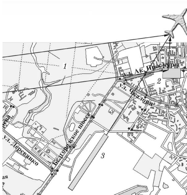
Рис. 4. Приёмо-передающие пункты и трассы самолётов: 1 — направление на передающую радиостанцию «Свобода», 2 — приёмный пункт, 3 — аэродром взлёта/посадки
