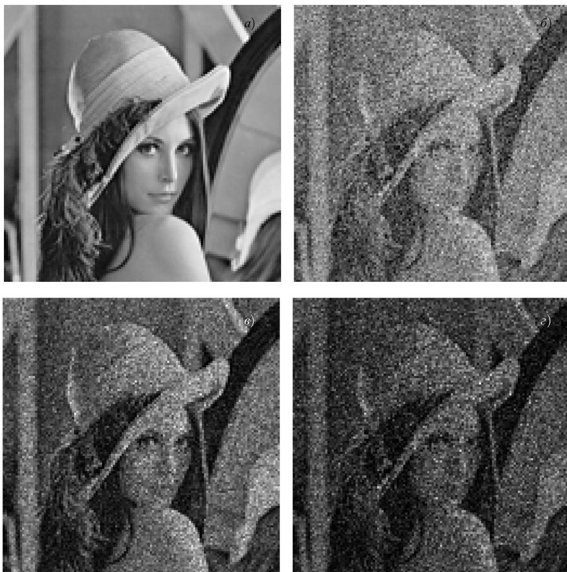
Рис. 3. Численно восстановленные изображения объекта при моделировании амплитудного ( а, б ) и фазового ( в, з ) пространственно-временных модуляторов света. Панели а и в соответствуют модулятору (голограмме) с 256 градациями оттенков, б и з — с 2 градациями
