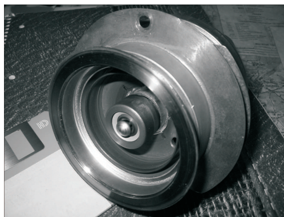
Рис. 2. Внешний вид низковольтной неадиабатической электронной пушки
