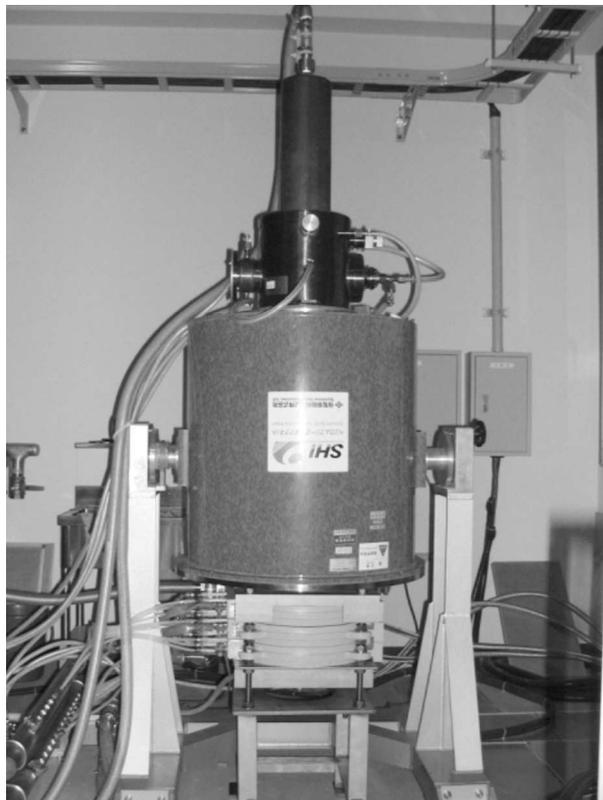
Рис. 5. Гиротрон с рабочей частотой 300 ГГц с «сухим» криомагнитом
