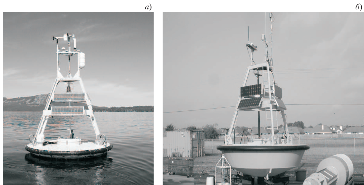
Рис. 1. Пример трёхметрового дискового буя: (а) в морских условиях и (б) на суше перед установкой
