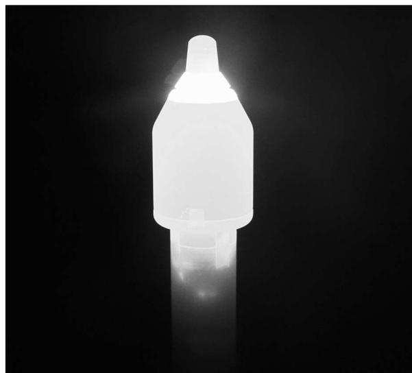
Рис. 5. Фотография нагретого катода
