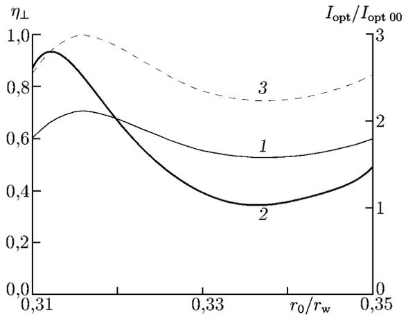
Рис. 8. Зависимость КПД (кривая 1) и нормированного оптимального рабочего тока  $I_{opt} / I_{opt\ 00}$  (кривая 2) от относительного радиуса ввода электронов для моды  $TE_{28,17}^{(-)}$ .  $I_{opt\ 00}$  — оптимальный по КПД ток для круглого резонатора. Также показано отношение  $\eta_{\perp}^{(-)} / \eta_{\perp\ 00}$  (кривая 3)
