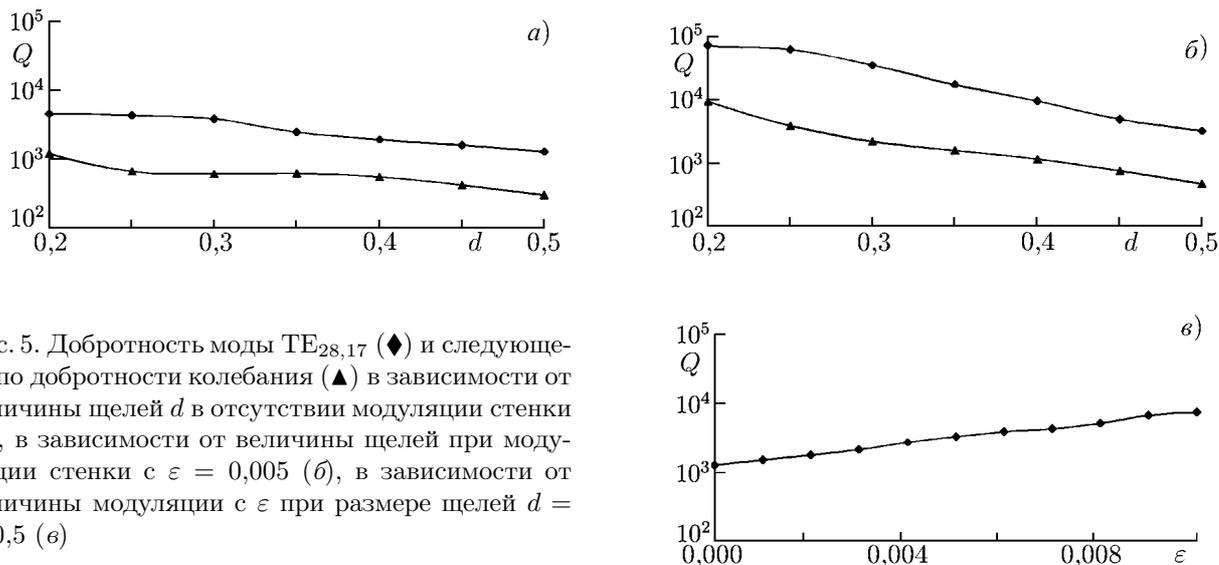
Рис. 5. Добротность моды TE<sub>28,17</sub> (◆) и следующего по добротности колебания (▲) в зависимости от величины щелей  $d$  в отсутствии модуляции стенки (а), в зависимости от величины щелей при модуляции стенки с  $\varepsilon = 0,005$  (б), в зависимости от величины модуляции с  $\varepsilon$  при размере щелей  $d = 0,5$  (в)
