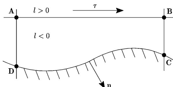
Рис. 2. Приближённые граничные условия на невозмущённой поверхности. Здесь  $l$  — расстояние между возмущённой и невозмущённой границей, так что  $l > 0$  при сужении резонатора и  $l < 0$  при его расширении,  $\mathbf{n}$  — внутренняя по отношению к металлу нормаль к поверхности;  $\boldsymbol{\tau}$  — единичный вектор, касательный к невозмущённой поверхности
