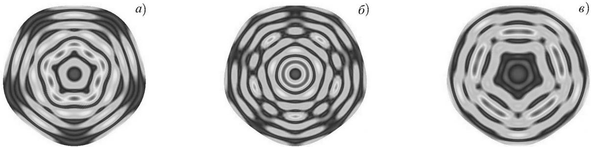
Рис. 4. Структура поля при модуляции стенки резонатора с  $\varepsilon = 0,025$ : (а) — высокочастотная мода  $TE_{8,5}$ , (б) — центральная по частоте мода  $TE_{3,7}$ , (в) — низкочастотная мода  $TE_{13,3}$
