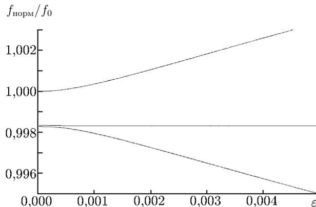
Рис. 3. Отношение  $f_{\text{норм}}/f_0$  нормальных частот колебаний к парциальной частоте  $f_0$  моды  $\text{TE}_{28,17}$  невозмущённого резонатора в зависимости от величины  $\varepsilon$  модуляции стенки резонатора
