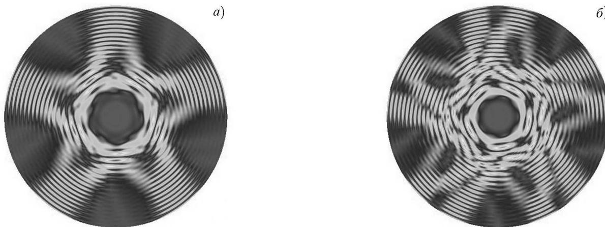
Рис. 6. Структуры поля двух наиболее добротных и близких по частоте колебаний: (а) мода  $TE_{28,17}$ , (б) ближайшее по частоте колебание. Наиболее добротное колебание (а) имеет хорошо выраженную структуру пятиконечной звезды
