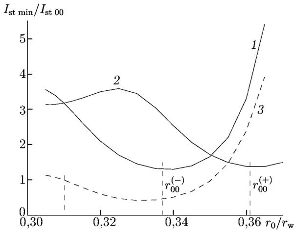
Рис. 7. Зависимость минимальных стартовых токов  $I_{st\ min}$  от относительного радиуса ввода электронного пучка для мод  $TE_{28,17}^{(\mp)}$  ( $TE_{28,17}^-$  — кривая 1,  $TE_{28,17}^+$  — кривая 2) в закрытом резонаторе с азимутально-периодической деформацией боковой поверхности при  $\epsilon \approx 0,006$ . Также показано отношение  $I_{st\ min}^{(-)} / I_{st\ min}^{(+)}$  (кривая 3).  $I_{st\ 00}$  — стартовый ток невозмущенного резонатора,  $r_w$  — его средний радиус
