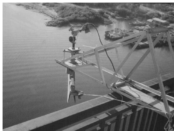
Рис. 2. Радиолокатор с ножевой диаграммой направленности в ходе эксперимента; ширина диаграммы направленности  $\delta_x = 1,5^\circ$ ,  $\delta_y = 24,5^\circ$
