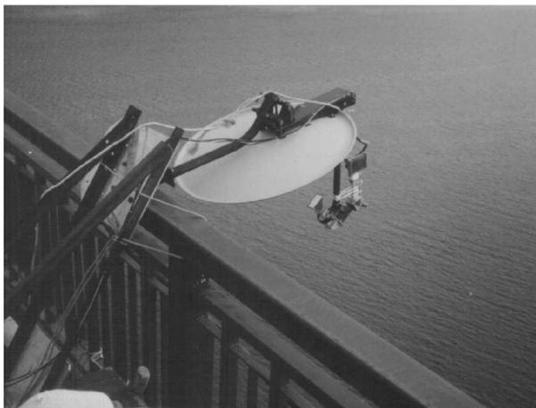
Рис. 1. Радиолокатор с узкой диаграммой направленности (параболическая антенна) во время измерений; ширина диаграммы направленности  $\delta_x = \delta_y = 3^\circ$
