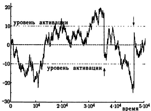
Рис. 4. Эволюция разности потенциалов на отдельном элементе сети. Стрелками указаны моменты пробоя (металлизации) активированной связи, когда происходит выравнивание потенциалов в соседних ячейках мелкомасштабной электрической структуры. Абсолютная величина разности потенциалов на концах связи меньше критической ( $U_c = 50$ ), следовательно, указанные пробой стимулированы ближайшими соседями
