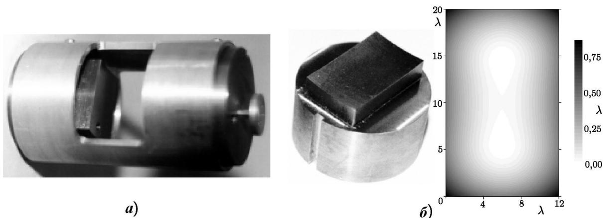
Рис. 7. Модель резонатора оротрона (а) и зеркало, создающее оптимальное распределение поля на решётке (в модели — на плоском зеркале) оротрона (б)
