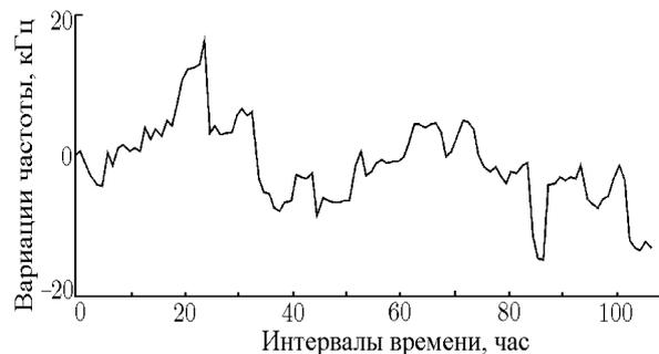
Рис. 5. Изменение положения частотной шкалы АОС относительно частотного репера в течение цикла наблюдений
