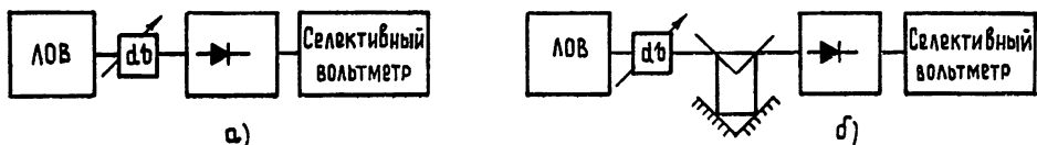
Рис. 1. а) Схема, позволяющая измерить флуктуации генератора только в сумме с собственными шумами детектора; б) схема с интерферометром Цендера—Маха, в которой компенсируются флуктуации генератора и тем самым выделяются шумы детектора.
