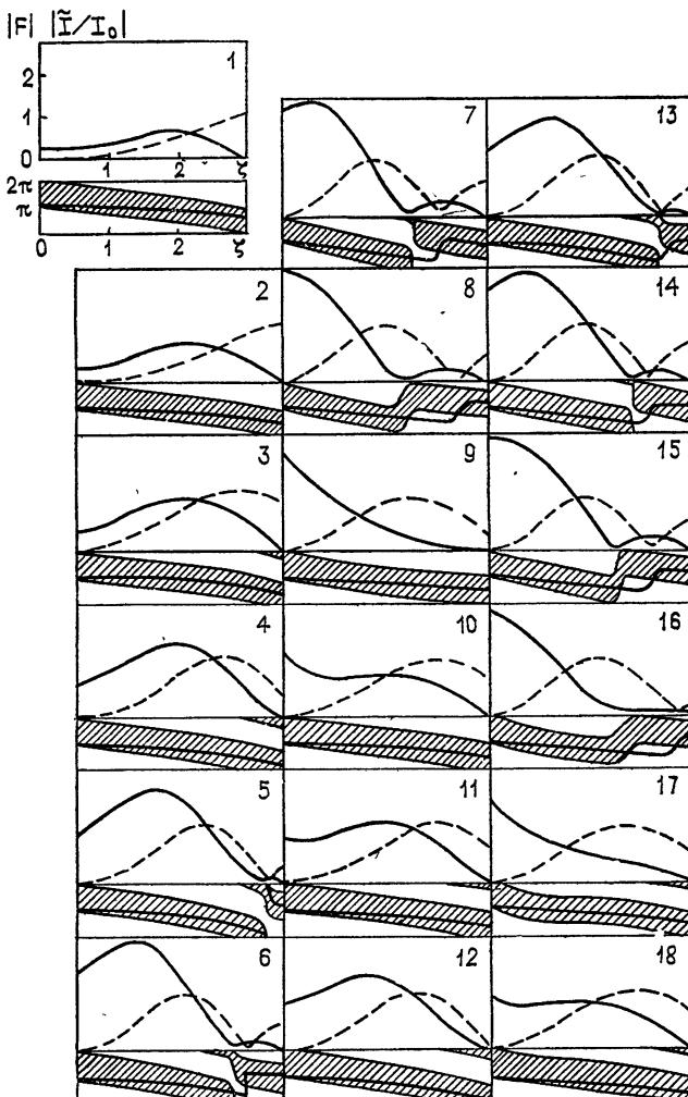
Рис. 6. Динамика распределения поля и высокочастотного тока по длине лампы при  $l=3$ . Каждый кадр показывает: вверху—амплитуды поля  $|F|$  (сплошная линия)
