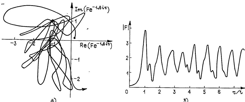
Рис. 5. Изменение комплексной амплитуды выходного сигнала слаборелятивистской ЛОВ в процессе установления при  $v \ll 1$ ,  $l = 5,25$ ,  $F_0 = 0,3$ ; а) траектория конца вектора  $F \exp(-1,6i\tau)$  на комплексной плоскости; б) зависимость  $|F|$  от времени.
