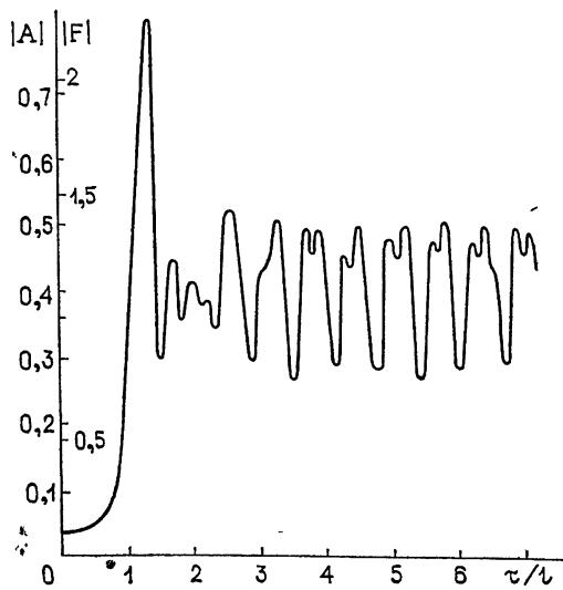
Рис. 9. Зависимость амплитуды выходного сигнала ультрарелятивистской ЛОВ от времени при  $I = 0,1$ ;  $I' = 4$  ( $\nu = 0,855$ ;  $l = 3,41$ ).
