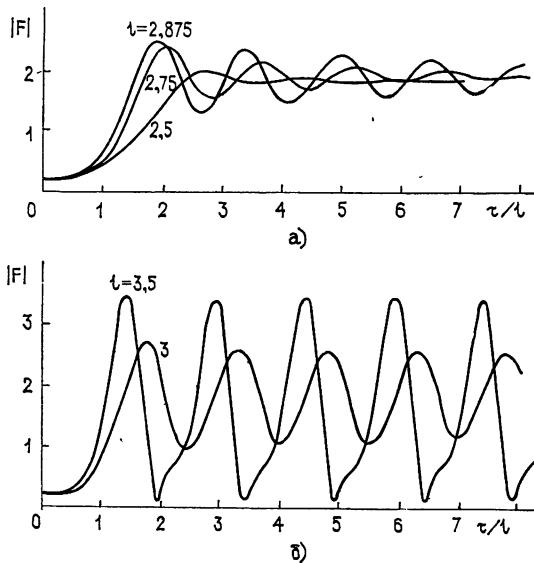
Рис. 3 Зависимость амплитуды выходного сигнала слаборелятивистской ЛОВ от времени в процессе установления колебаний при  $v \ll 1$ ,  $F_0=0,2$ .
