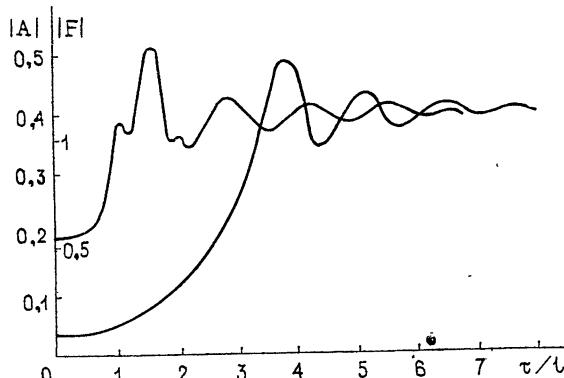
Рис. 7. Зависимость амплитуды выходного сигнала ультраколлектористской ЛОВ от времени для двух различных уровней начального толчка при  $I = 0,1$ ,  $I' = 2,6$  ( $\nu = 0,855$ ;  $l = 2,2$ ).
