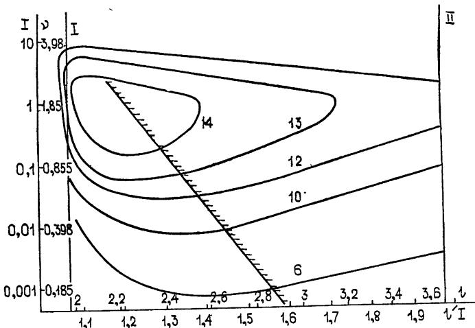
Рис. 8. Примерное положение области автомодуляции (заштрихована) на плоскости параметров  $I, I' I^{1/3}$  или  $\nu, l$ . Вертикальные линии I и II показывают границы самовозбуждения основной и второй моды.
