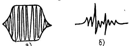
Колебания в контуре имели вид, показанный на рис. 3. Из рисунка видно, что огибающая сигнала имеет форму, близкую к прямоугольной,
