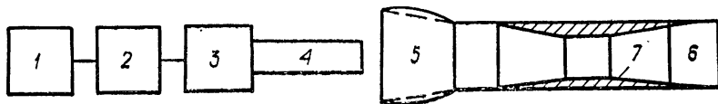
Рис. 5 Схема установки для измерения коэффициента преобразования: 1—генератор, 2—измерительная линия, 3—преобразователь Марье, 4, 6—волноводы кругового сечения, 5—конический отражатель, 7—подвижная втулка.
