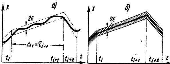
Рис. 5. Дискретизация (а) и приближенное воспроизведение (б) сигнала  $x(t)$  многочленом  $\bar{x}(t)$  первой степени (линейное приближение).
