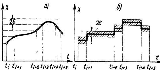
Рис. 4 Дискретизация (а) и приближение (б) сигнала  $x(t)$  многочленом  $\bar{x}_i(t)$  нулевой степени.
