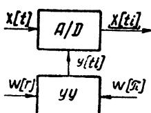
Рис. 2. Схема блока дискретизации и квантования:  $A/D$  — устройство преобразования мгновенного значения сигнала  $x(t)$  в соответствующий эквивалент  $x(t_i)$ ;  $УУ$  — управляющее устройство (определение момента отсчета);  $y(t_i)$  — сигнал разрешения отсчета;  $W(\Pi)$  и  $W(\Gamma)$  — внешние воздействия соответственно со стороны потребителя  $\Pi$  и источника  $\Gamma$  информации.
