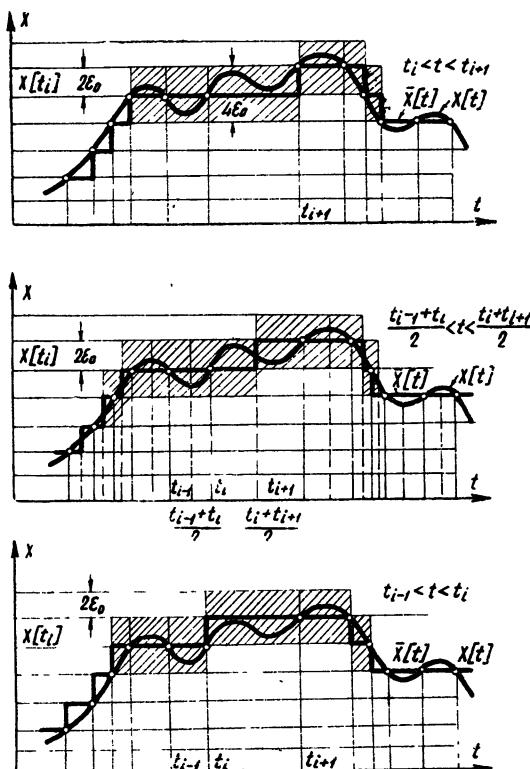
Рис. 3. Возможные случаи определения интервала существования приближающего многочлена  $\bar{x}(t)$  при квантовании по уровню.
